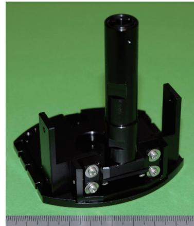
図2 鏡筒部部品。対物レンズ、ダイクロイックミラー、励起・反射照明用コンデンサーを取り付けるもの((a)左)と、蛍光フィルターを取り付けるもの((a)右)の2つあり、(b)は励起・反射照明用コンデンサーを取り付けた写真である。
